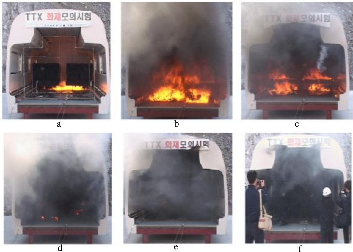
شکل ۷- تست آتش سوزی در مقیاس بزرگ بدنه کامپوزیتی به همراه قطعات داخلی: (a) شروع، (b) پس از ۲۰ ثانیه، (c) پس از ۳۰ ثانیه، (d) پس از ۴۰ ثانیه، (e) پس از ۵۰ ثانیه، (f) پس از ۲۹۰ ثانیه [۶]
