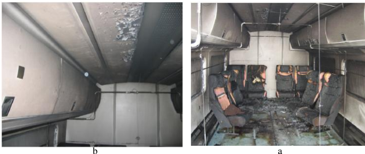
شکل ۸- (a) داخل بدنه مورد آزمایش، (b) رنگ پوسته شده سقف بعد از خاموش شدن آتش [۶]
