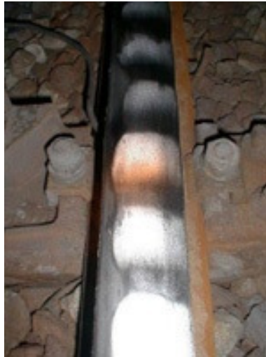
تصویر شماره ۹ - موج‌دار شدن سطح ریل
